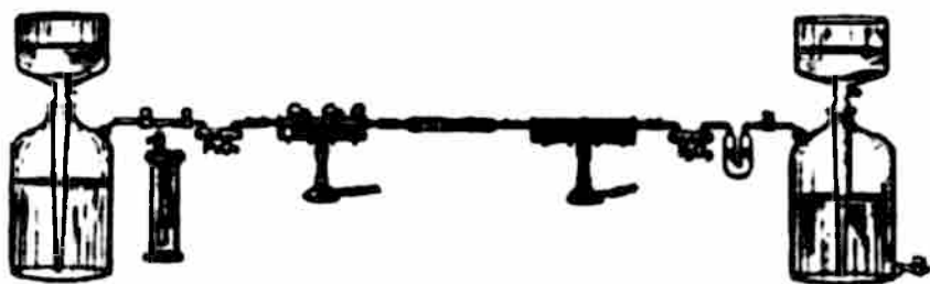
Atmosferadan azot va kislorodni ajratadigan U. Ramzay asbobi.
