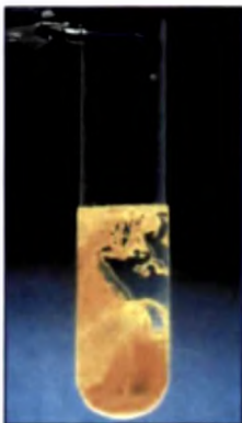
Рис. 49. Образование осадка AgI при взаимодействии \text{AgNO}_3 с \text{NaI}
