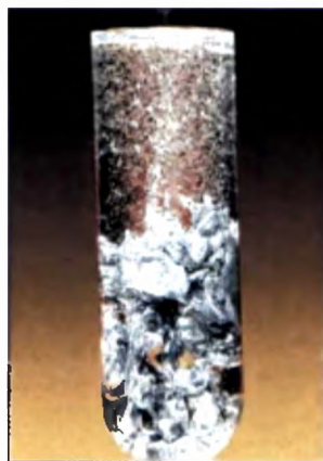
Рис. 25. Вытеснение водорода цинком из соляной кислоты
