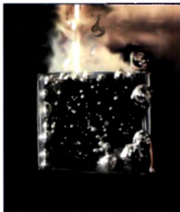
Рис. 42. Растворение цинка в серной кислоте и выделение водорода
