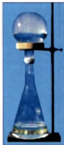
Рис. 47. Растворение газообразного HCl в воде и образование раствора соляной кислоты
