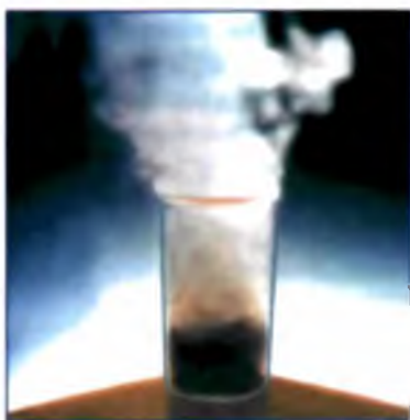
Рис. 19. Разложение \text{H}_2\text{O}_2 в присутствии \text{MnO}_2
